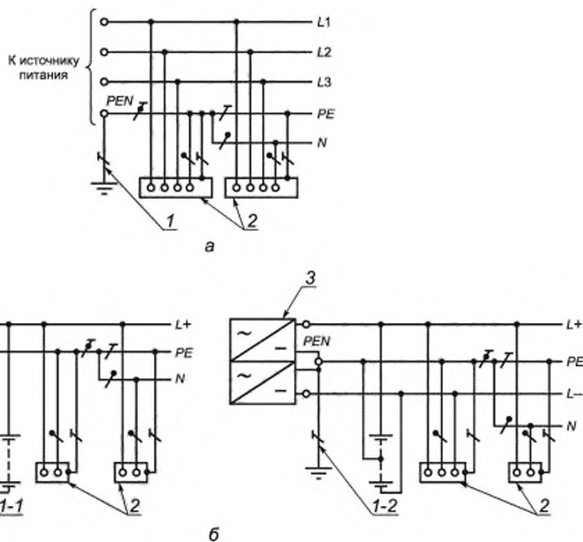
1 — заземлитель нейтрали источника переменного тока; 1-1 — заземлитель вывода источника постоянного тока; 1-2 — заземлитель средней точки источника постоянного тока; 2 — открытые проводящие части; 3 — источник питания
