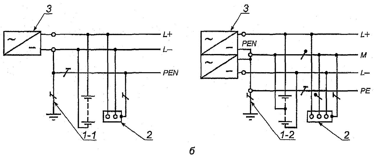
1 — заземлитель нейтрали источника переменного тока; 1-1 — заземлитель вывода источника постоянного тока; 1-2 — заземлитель средней точки источника постоянного тока; 2 — открытые проводящие части; 3 — источник питания
