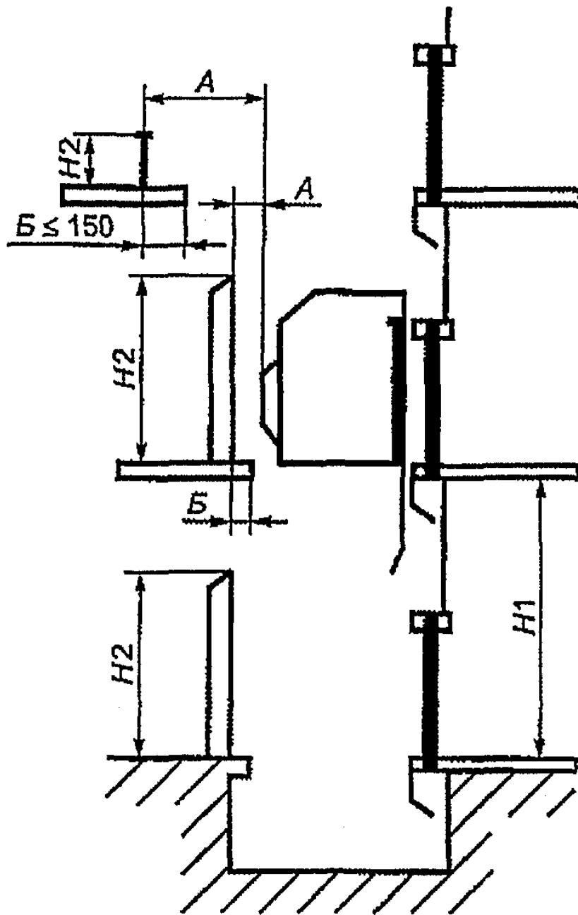
*A* — расстояние до движущихся элементов лифта; *Б* — расстояние между ограждением и краем межэтажных перекрытий, ступеней и площадок; *H<sub>1</sub>* — высота ограждения со стороны этажной площадки; *H<sub>2</sub>* — высота ограждения с остальных сторон
